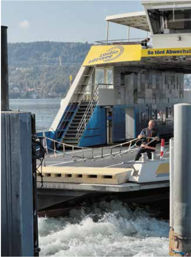
Auf den Fähren sorgen mittlerweile Holz-Konstruktionen dafür, dass die Einfahrtsrampe flacher aufliegt.
