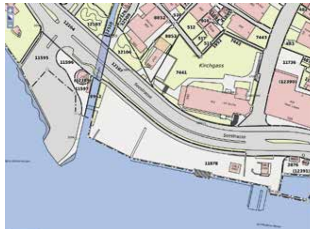
Meilens Seeufergrenze – strichpunktiert dargestellt – im Planausschnitt bei Kirche und Fähre (maps.zh.ch/amtliche Vermessung in Farbe).
