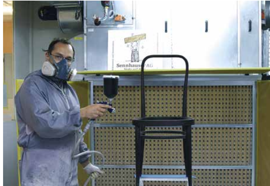
Sicherheit geht vor: Trotz der neuen Farbnebel-Absauganlage, die optimale Arbeitsbedingungen schafft, ist die korrekte Schutzkleidung Pflicht – Oberflächenspezialist Markus Bolt bei der Arbeit. Foto: MAZ
