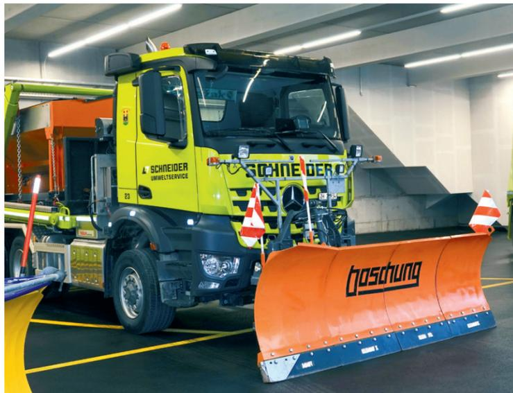
Das neue Winterdienstfahrzeug kann ausserhalb der Wintermonate zum Muldenfahrzeug umfunktioniert werden. Foto: MAZ
