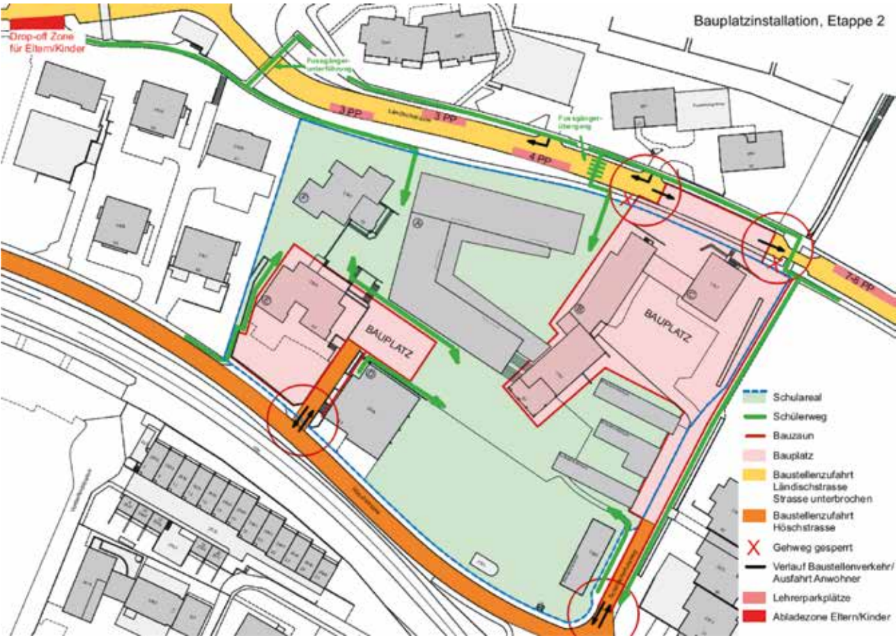
2. Etappe: Bauplatzinstallation und Erschliessung.
