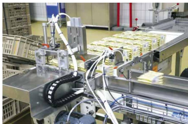
An der neuen Linie 18 werden die Portionen automatisch abgepackt.
